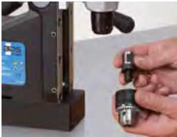
1. Unir el adaptador con el portabrocas.
