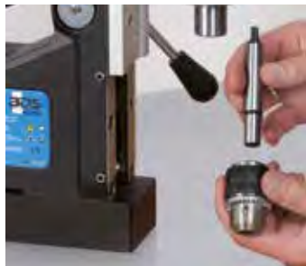
1. Unir el mandril cónico con el portabrocas.
