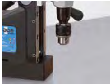
2. Colocar el portabrocas en el portaherramientas directo.
