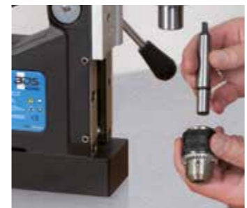
1. Соедините конусную оправку со сверлильным патроном.
