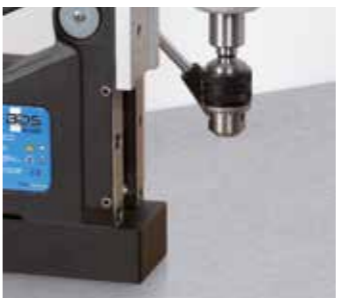
2. Вставьте сверлильный патрон в крепление МК.
