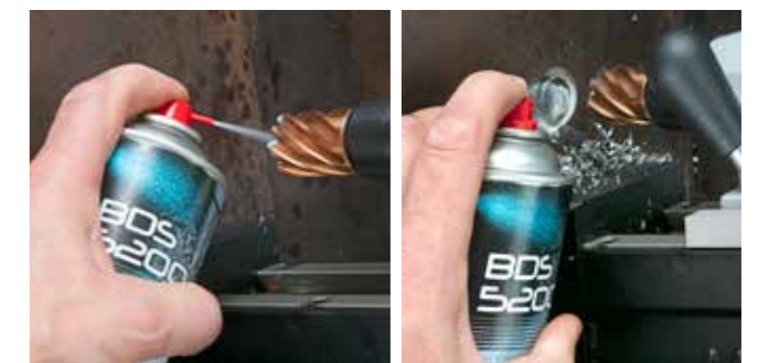
Этап 1: Перед сверлением распылите высококачественный смазочный спрей прямо на сверло.
