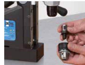
1. Соедините переходник со сверлильным патроном.
