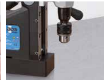
2. Вставьте сверлильный патрон в систему непосредственного крепления инструмента.
